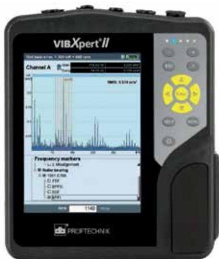
*\*Вибродиагностика* – метод диагностирования технических систем и оборудования, основанный на анализе параметров вибрации, создаваемой работающим оборудованием. Периодические замеры вибрации позволяют своевременно выявлять износ деталей компрессора.
