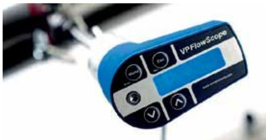
Измерения проводим с помощью расходомера VPFlowScope M. Этот прибор производит одновременные замеры массового расхода, давления и температуры.
