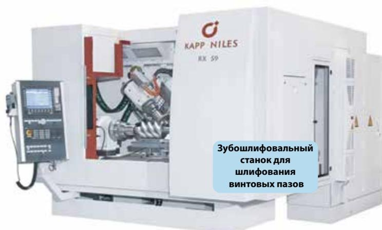
Зубошлифовальный станок для шлифования винтовых пазов
