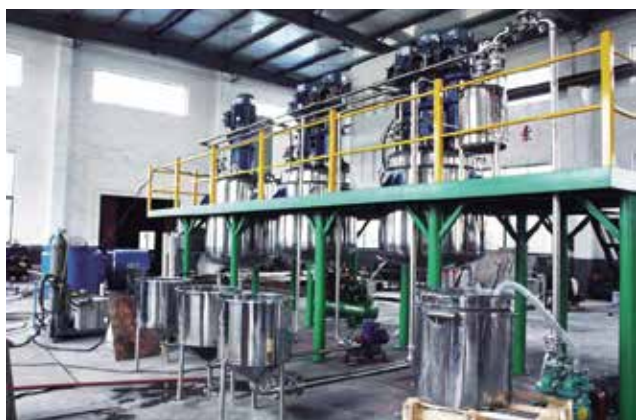
Автоматическая линия производства красок
